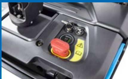
Smart-DH1232-PL mit USB-Anschlussmöglichkeit und Geschwindigkeitsanzeige
