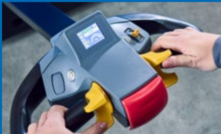
Multifunktionale Deichsel mit modernem digitalem Display
