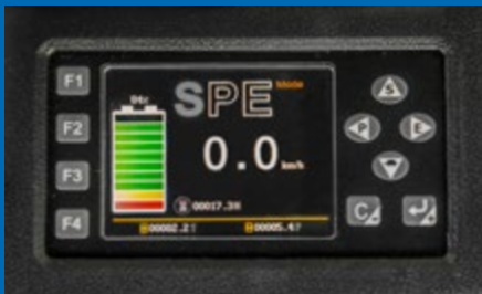
Multifunktionales Bedienungselement mit Farbbildschirm
