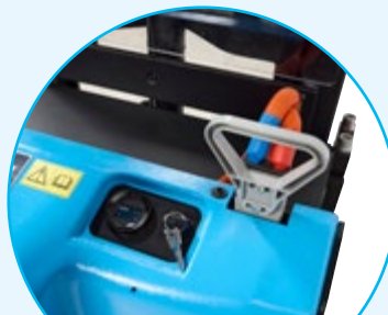
Mit Batterie-standsanzeige und Schlüsselschalter
