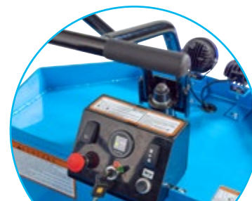
Einfache und übersichtliche Bedienung mit digitaler Geschwindigkeitsanzeige
