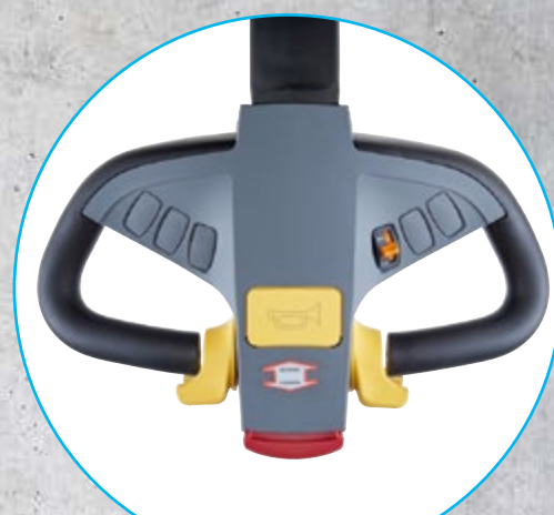
Neuer Deichselkopf für feinfühligere Steuerung durch Wippschalter
