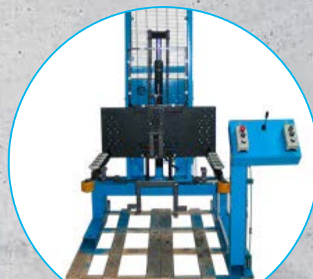
Elektrohochhubwagen mit elektronischer Bedienstation und kundenspezifischer Aufnahme
