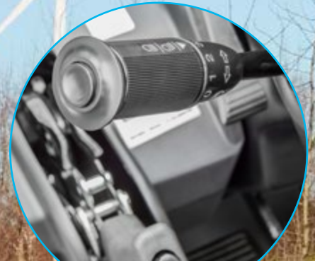
Fahrtrichtungsschalter mit 3 Vorwärtsgängen – Stapler erreicht Höchstgeschwindigkeit von bis zu 26 km/h
