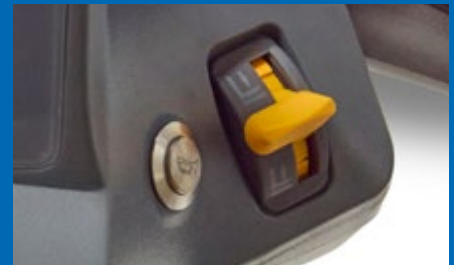
Schalter an der Deichsel für fein dosierbares Heben und Senken
