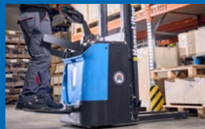
Deichselstapler-Smart-DH-12 mit Mitfahrerplattform und Seitenbügeln für mehr Sicherheit
