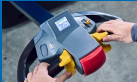
Ergonomische Deichsel mit moderner digitaler Anzeige
