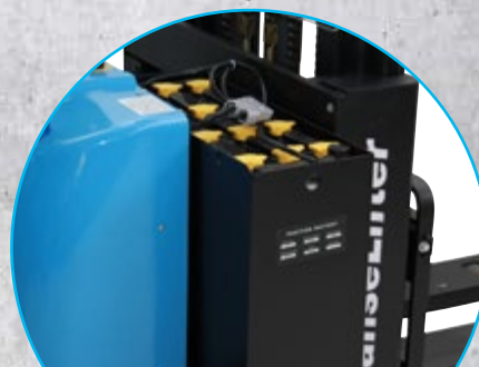
Durch das beidseitig zugängliche Wechselsystem lassen sich Batterien schnell und einfach tauschen.
