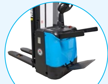
Mit Mitfahrerplattform und Seitenbügeln für mehr Sicherheit
